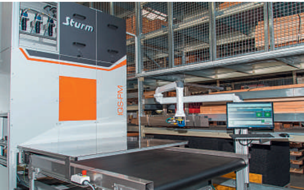
In dieser Anlage der Sturm-Gruppe werden Blechteile mit Hilfe von Bildverarbeitung mit ihren CAD-Daten verglichen
